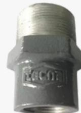
Los hubs de sellado a prueba de explosión fabricados por TECNA S.A. se utilizan para el acople en áreas clasificadas de tuberías conduit a cajas a prueba de explosión en posición vertical. Su función es similar a la de los sellos cortafuego y requieren para su correcto funcionamiento la instalación de compuesto sellante y fibra retenedora.
